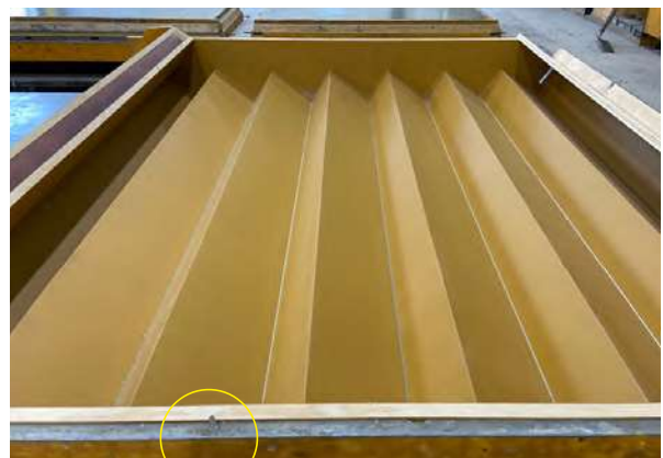
Treppenschalung im Fertigteilwerk
